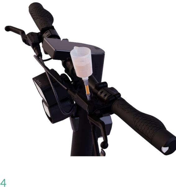
1. Ziehe nun den Kolben der Einfüllspritze langsam nach hinten (siehe Bild 1), sodass sich die Spritze mit Bremsflüssigkeit aus dem System füllt.
