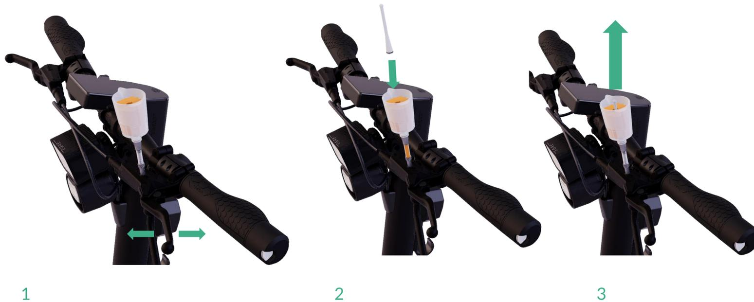
1. Bevor du den Trichter wieder entfernst, betätige den Bremshebel **mindestens sieben Mal** (siehe Bild 1), um verbleibende Restluft aus dem System zu entfernen und sicherzustellen, dass das System vollständig entlüftet ist.
